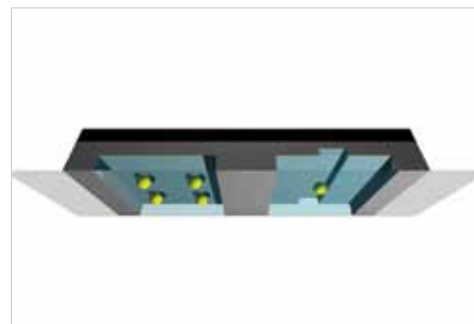
«Glassandwich» mit einer glatten und einer mit Vertiefungen gravierten Glasscheibe. (Bild: Madhavi Krishnan/ETH Zürich)
